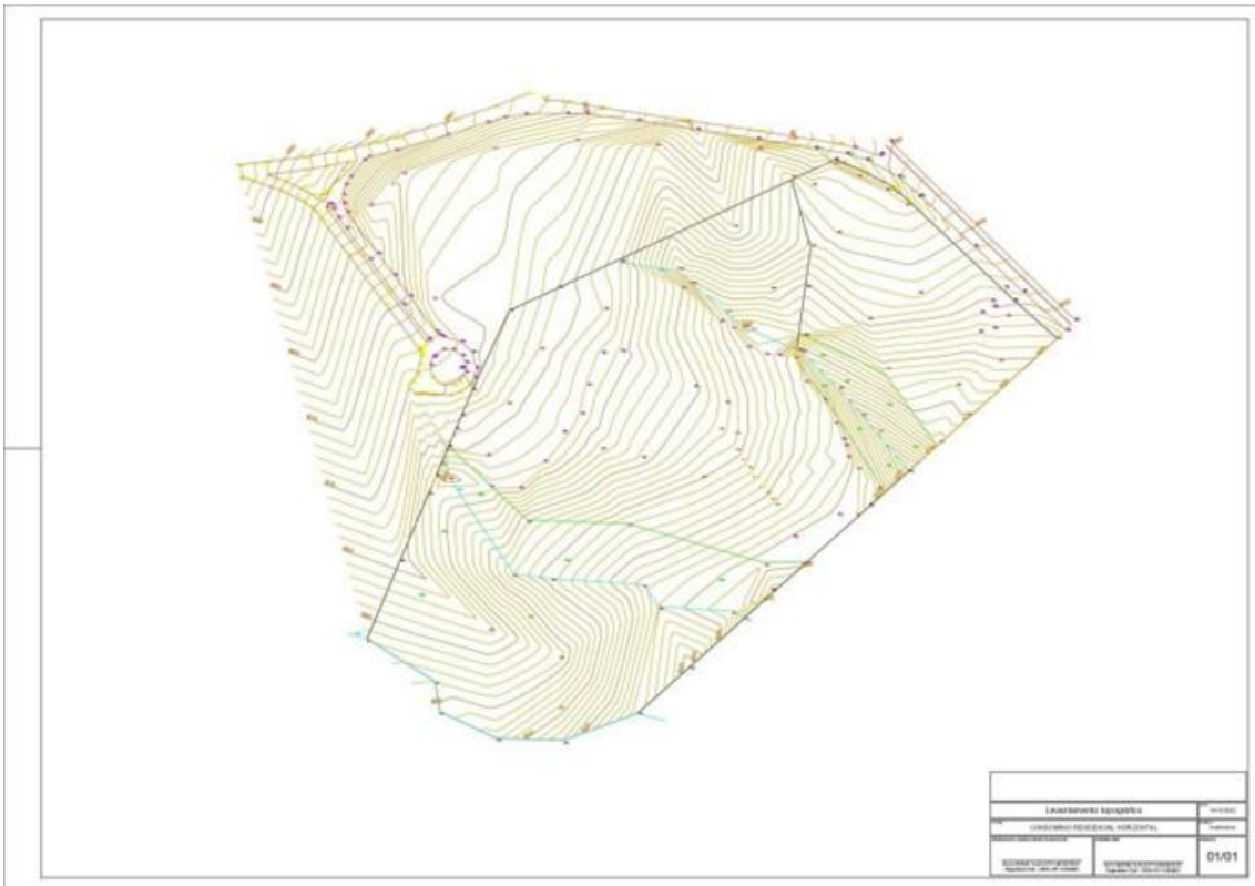
Figura 4: Plano Altimétrico Condomínio EcoGardenns
