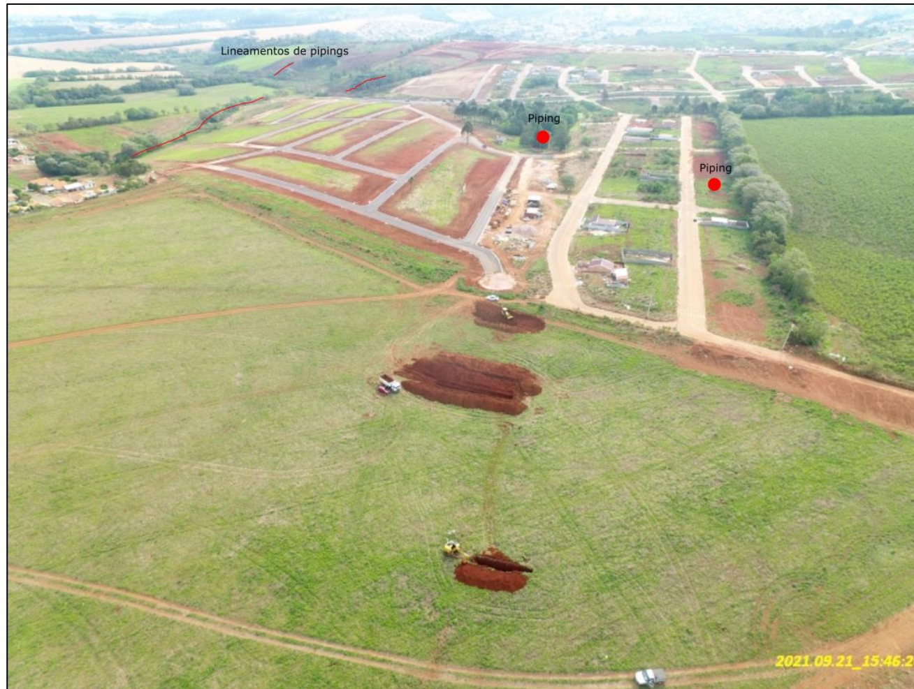
Relação da área de estudo com as demais ocorrências de pipings em seu entorno
