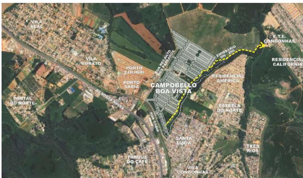
Figura 23 – Traçado previsto para o emissário de esgoto sanitário
