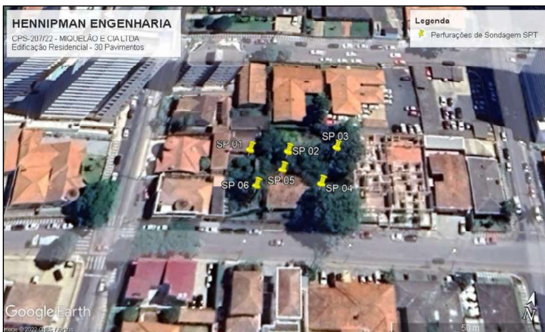
Figura 01 – Localizações aproximadas das perfurações de Sondagem SPT – Rua Ricardo Lustosa Ribas, 200 – Estrela, Ponta Grossa-PR – CEP: 84.040-140.
