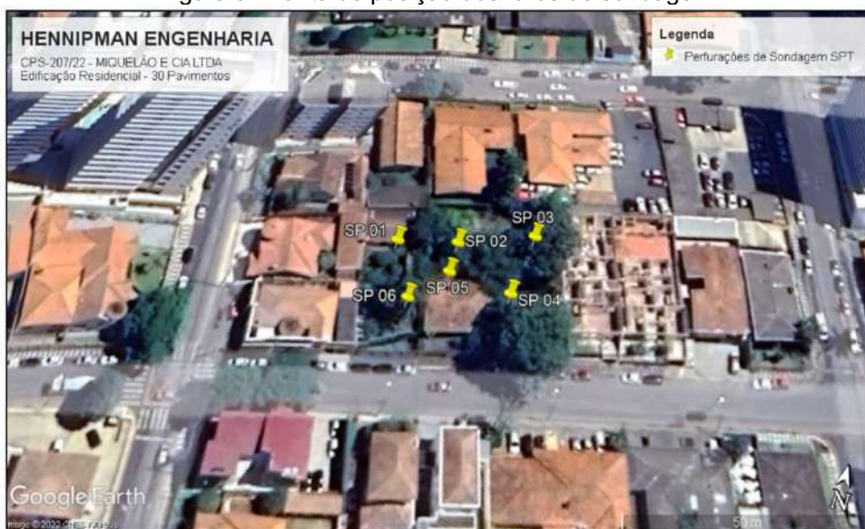
Figura 9. Planta de posição dos furos de sondagem.
