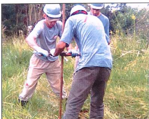
Fotografia 01: Sondagem a trado manual.
