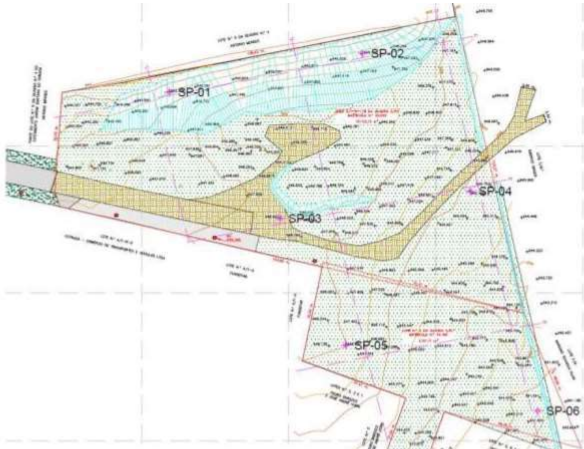
Figura 3 – Pontos de sondagem.
