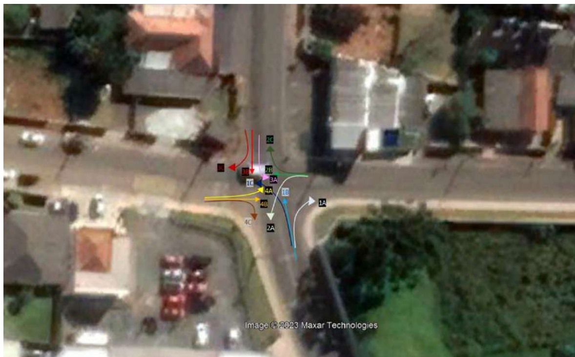
Figura 36 - Movimentos contados no cruzamento 1.
