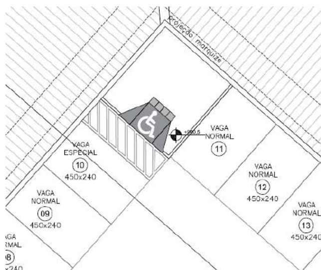
Figura 30 – Acesso para pessoas portadoras de deficiência com dificuldade de locomoção.
