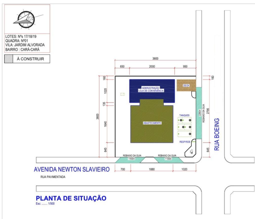
Figura 4: Planta de situação.
