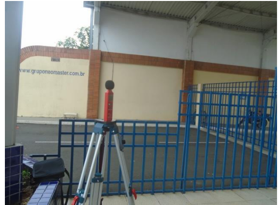
Figura 77: Medição de ruído na portaria do Colégio Neo Master.
