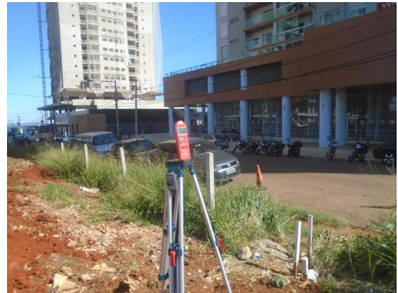
Figura 79: Medição do ruído em um dos pontos de inserção do empreendimento.
