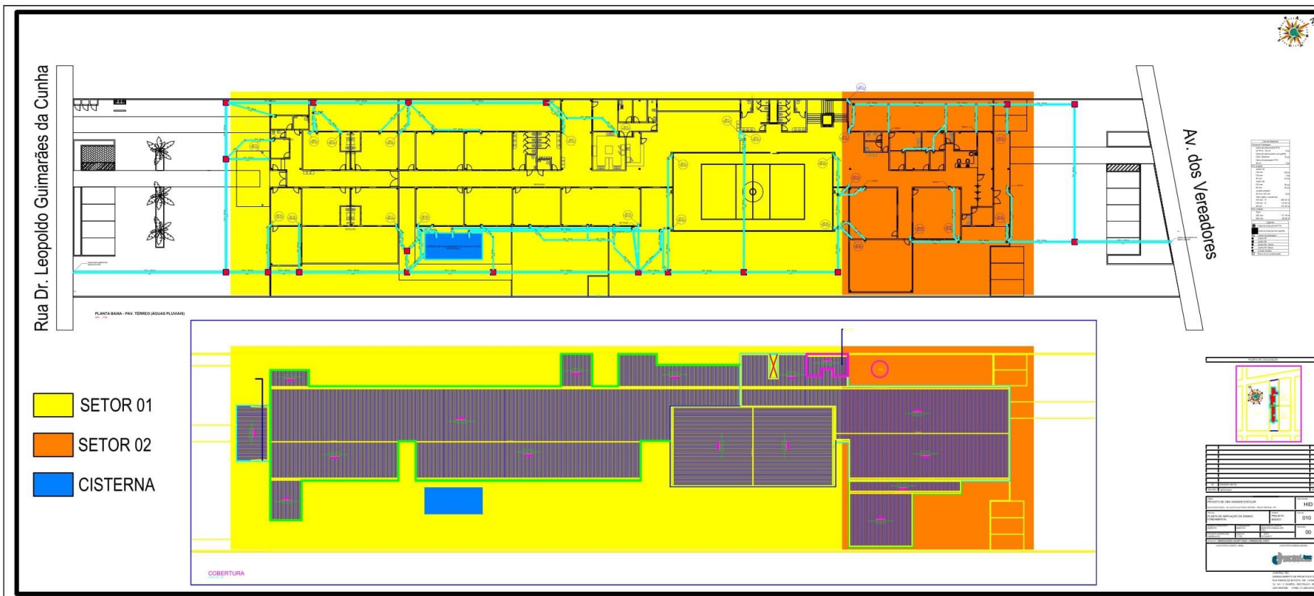
Figura 60: Croqui de divisão de escoamento das águas pluviais
