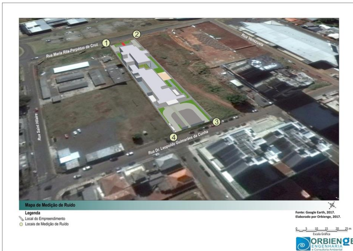
Figura 80: Pontos de medição de ruído realizados no local de inserção.
