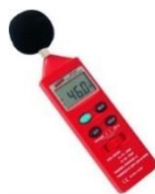
Figura 67: Equipamento de medição de ruído Decibelímetro.
