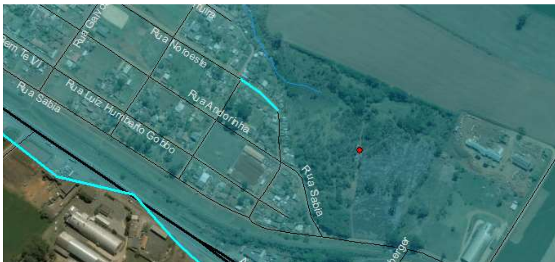
Figura 33 - Rede de esgoto identificada nas proximidades do empreendimento. Fonte: Adaptado de Iplan, 2017.
