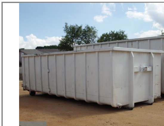
Figura 122: Modelo de caçamba do tipo Roll-on Roll-off
