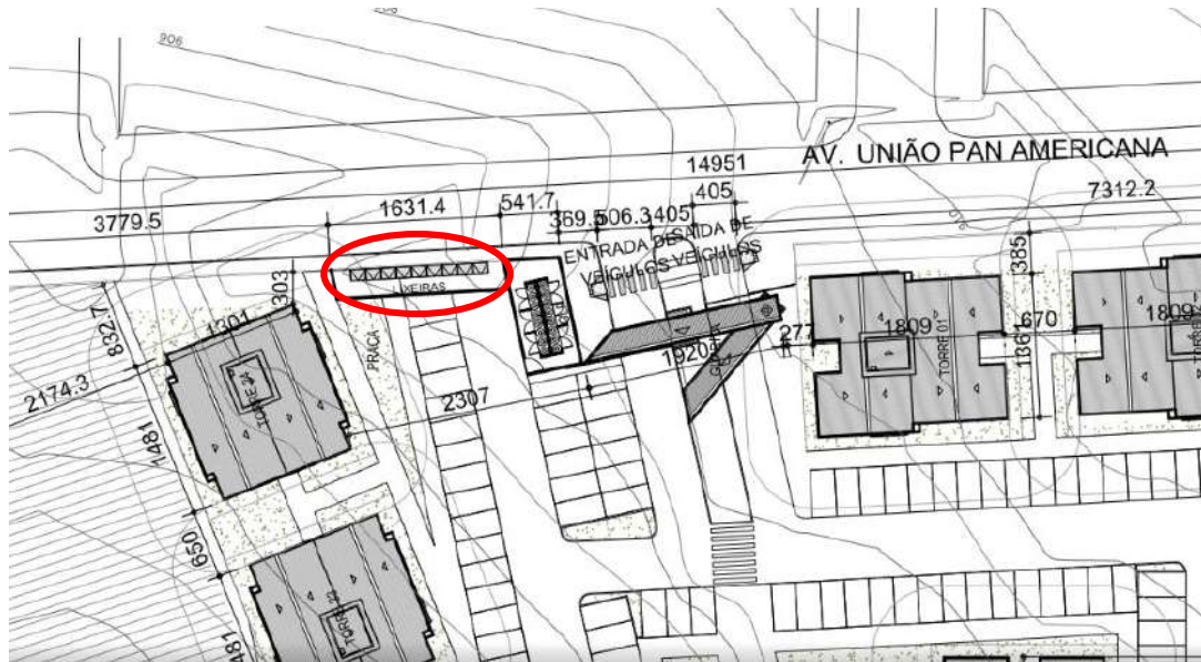
Figura 33 - Local destinado para as lixeiras de resíduos orgânicos e recicláveis Fonte: Adaptado do Projeto Arquitetônico (2016).
