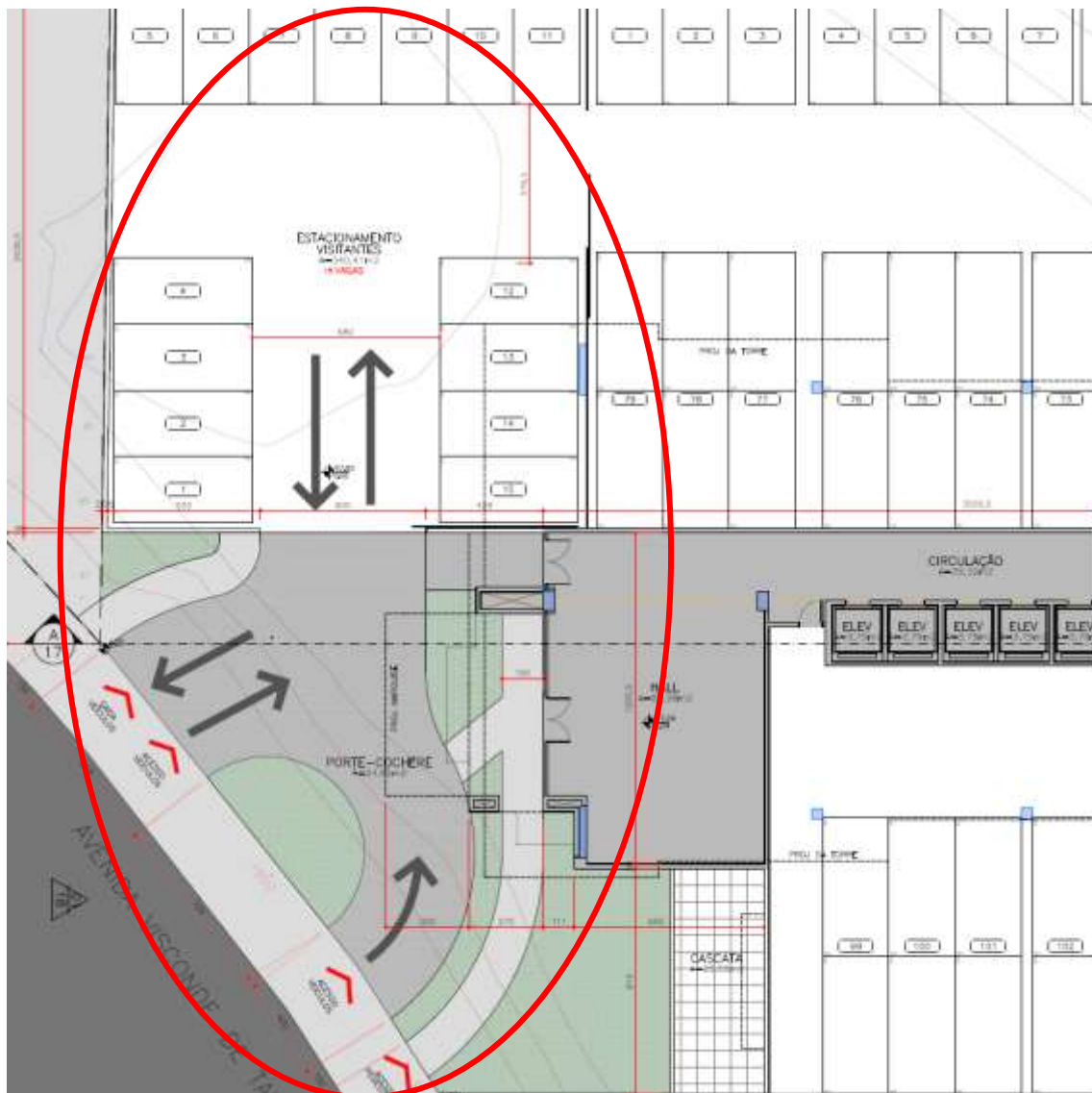
Figura 31 – Acessos pela Avenida Visconde de Taunay no térreo
