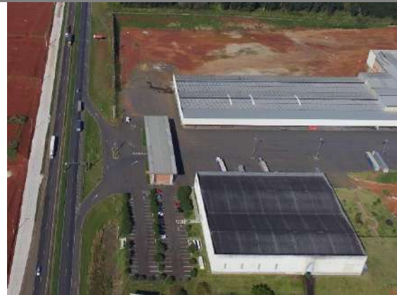
Figura 57: Vista geral das pistas de acesso com faixas de desaceleração e aceleração. Autor: Orbienge, 2021.
