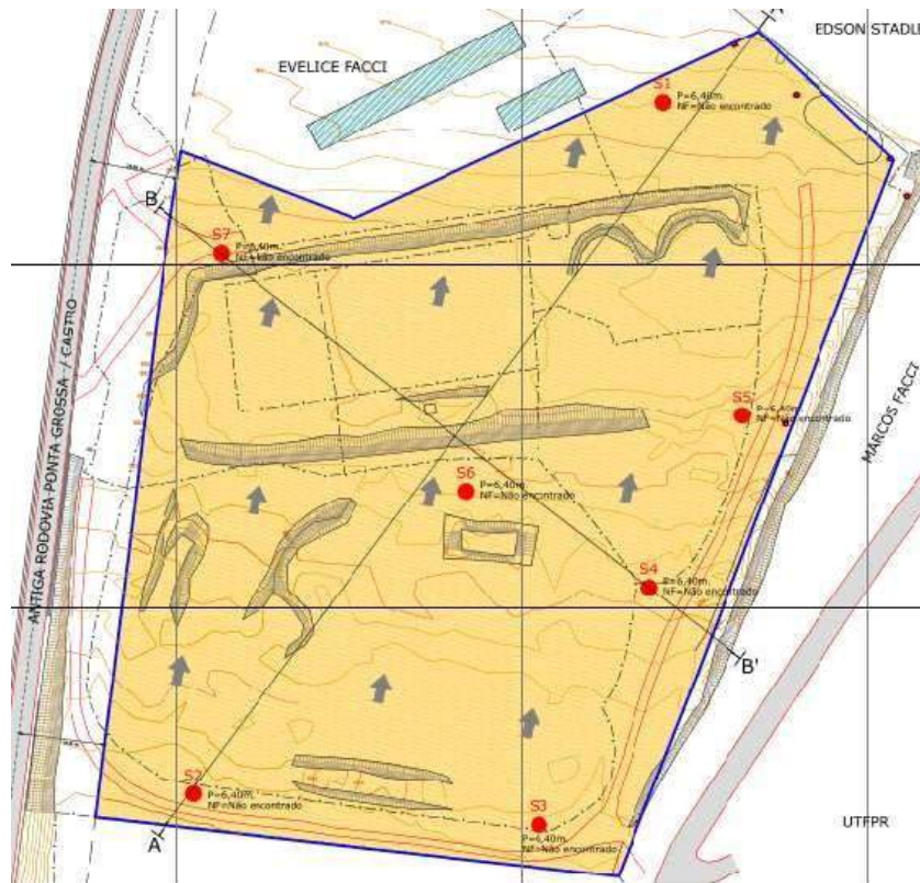
Figura 4 – Pontos de sondagem.
