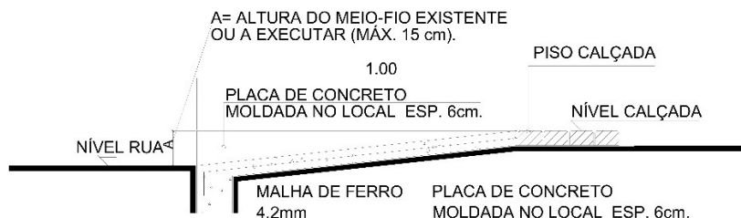
Figura 32: Corte - Rampa de acessibilidade.
