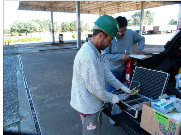
Sondagem ST02 - medição de COV's
