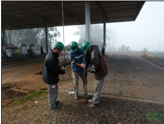
Momento de medição de COV's - piso permeável
