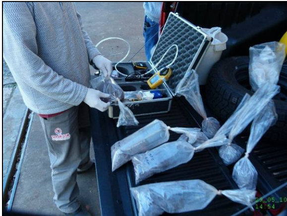
Sondagem ST05 – medição de COV's
