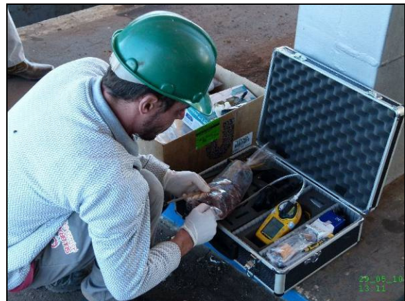
Sondagem ST03 – medição de COV's
