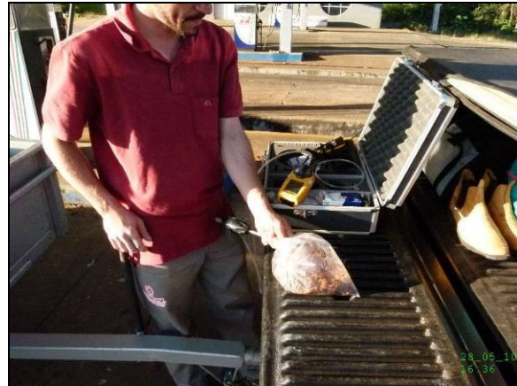
Sondagem ST01 – medição de COV'S
