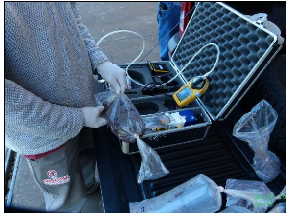
Sondagem ST05 – medição de COV's
