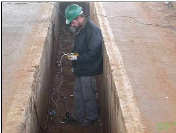
Momento de medição de COV's – vala de lubrificação
