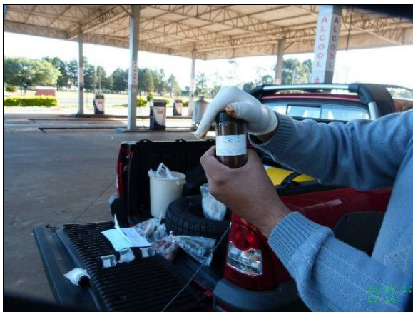
Procedimento para coleta das amostras – preenchimento total dos frascos
