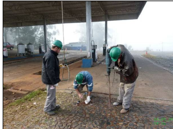
Momento de medição de COV's logo após a retirada da broca de perfuração - piso permeável
