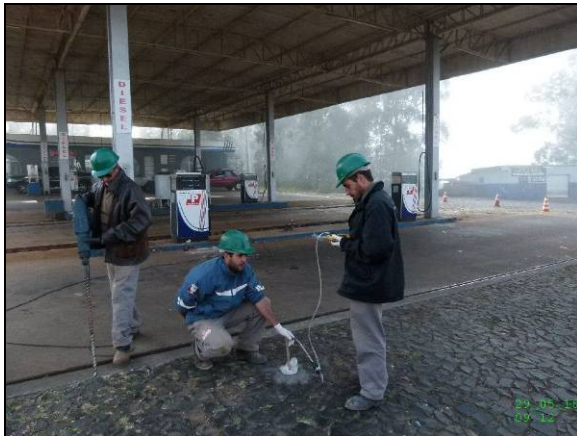
Momento de medição de COV's - piso permeável
