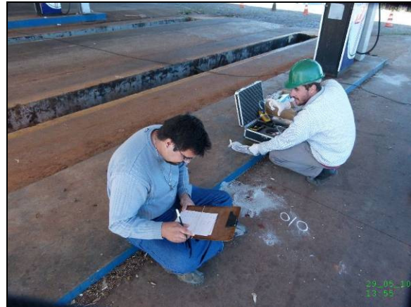
Sondagem ST04 – medição de COV's
